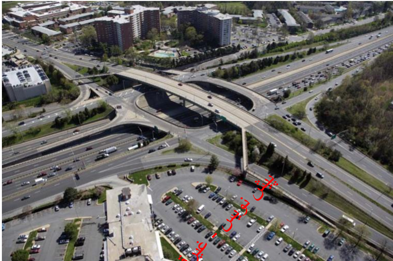
شکل ۶-۲۰- آزادراه با یک تبادلهای لوزوی سه طبقه
