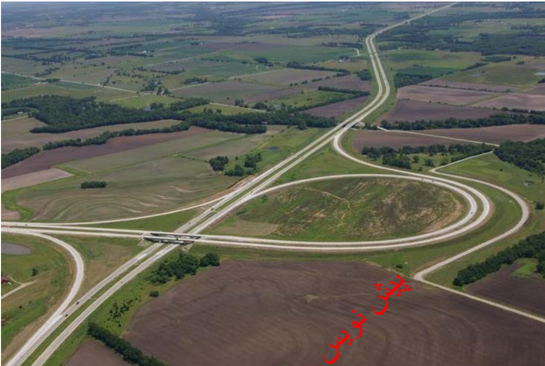
شکل ۶-۱۳- تبادل شبدری آزادراه با آزادراه
